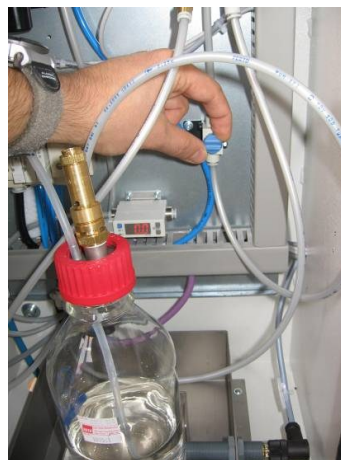
Abb. 1 Stickstoffzufuhr (Druckbehälter) verriegeln
