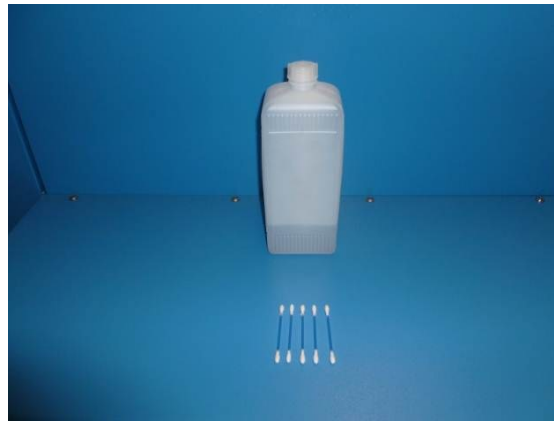
Abb. 9 Reinigungsutensilien (Wattestäbchen, Isopropanol)
