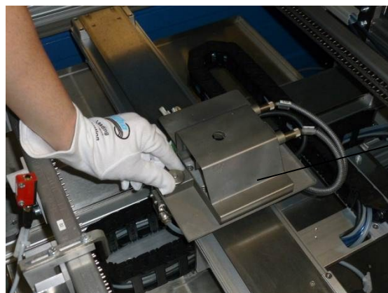
Abb. 4 Abdeckung am Fluxerkopf entfernen
