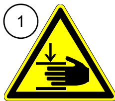
Abb. 3 - 9 Warnung vor Handverletzung - Crushing of fingers
