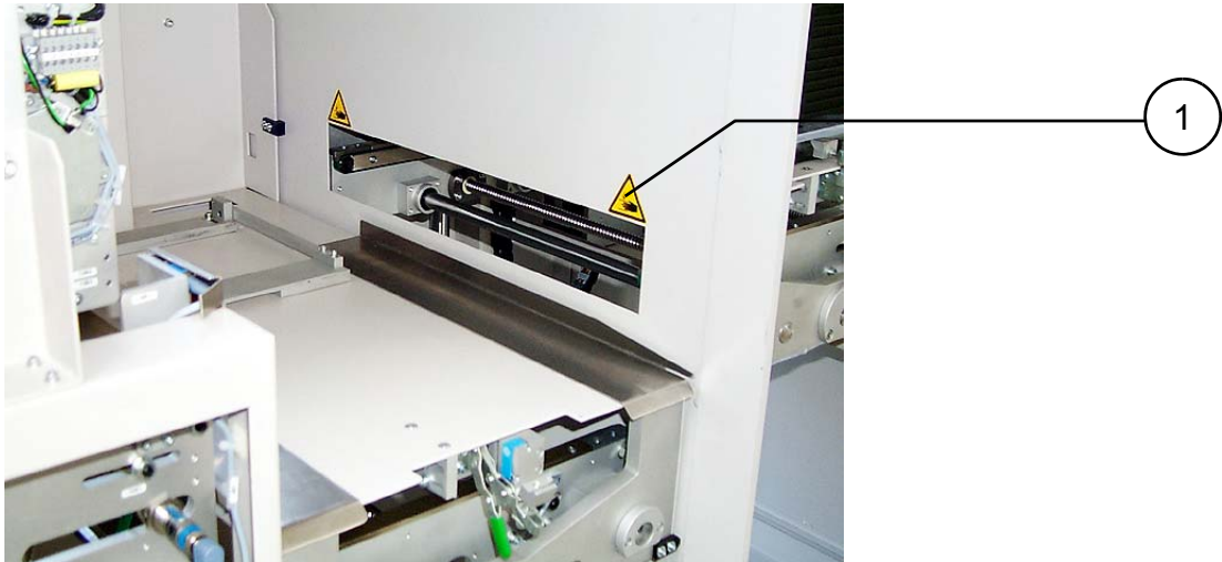
Abb. 3 - 8 Warningschilder am Trennblech
