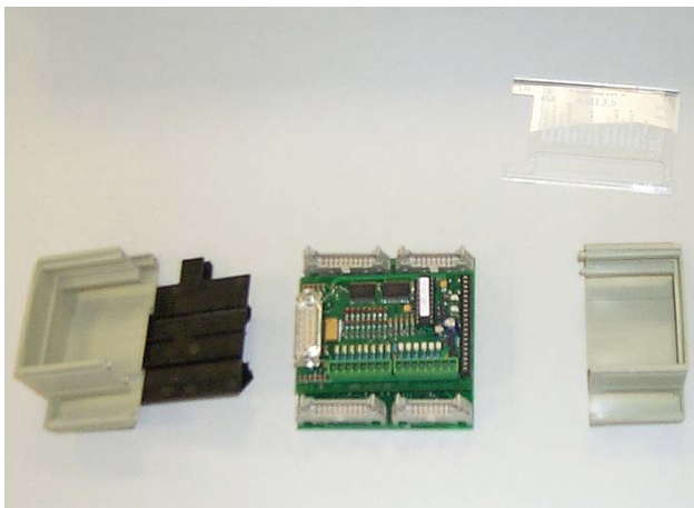
Abb. 10 - 9 Schnittstellenmodul öffnen - Bild 2 und 3
