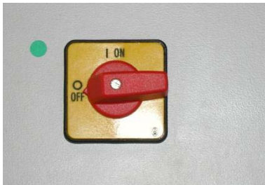
Abb. 3 - 3 Alternativer Haupt- und Not-Halt-Schalter
