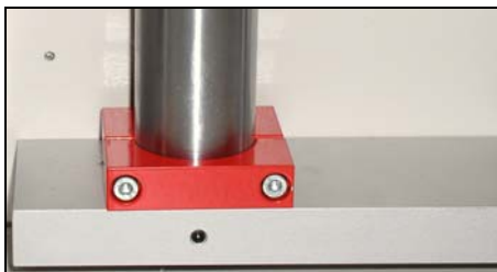
Beispielabbildung Transportsicherung an Hubachse
