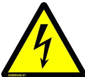
Abb. 3 - 4 Warnaufkleber an spannungsführenden Teilen
